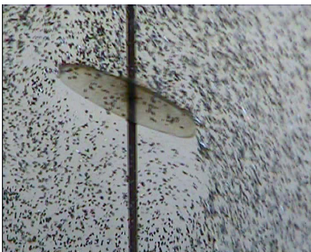
Bild 34: Strömungssichtbarmachung mit Aluminiumflitter
