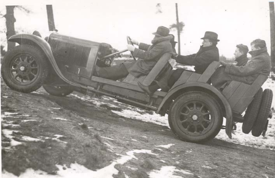
Bild 42: Föttingers Versuchswagen (Mercedes 8/35) mit Strömungsgetriebe
