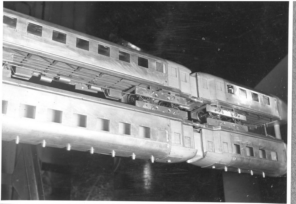
Bild 55: Ansicht des detailgetreuen Windkanalmodells von Schnellzugwagen
