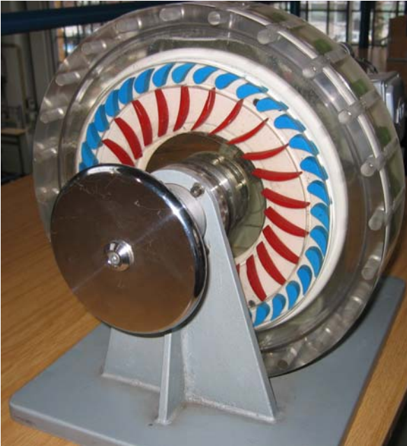
Bild 11: Funktionsmodell eines Föttinger-Wandlers
