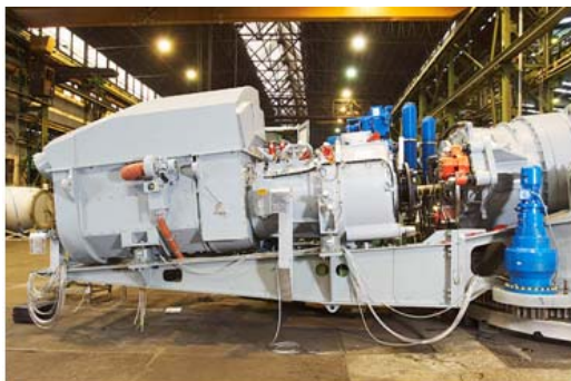
Montage des ersten WINDRIVE® Prototyp in der Gondel im Dezember 2006
