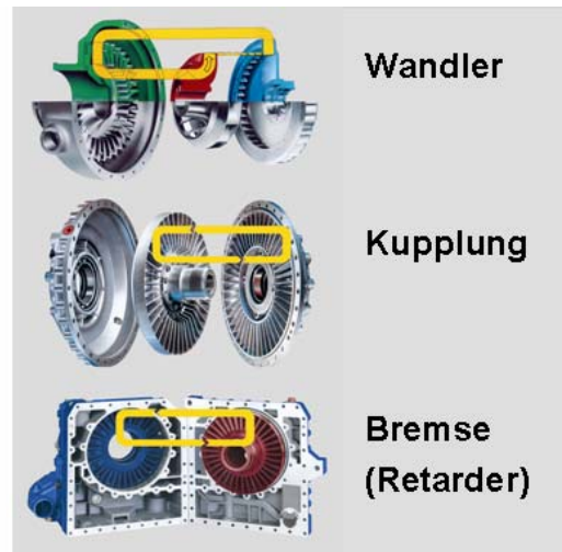
Bauformen der Föttinger-Aggregate
